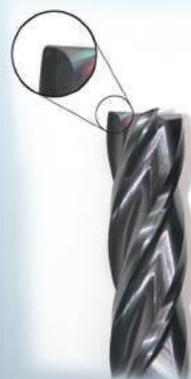
Острая вершина ослаблена с двух сторон задними углами, в то время как радиус перехода (фаска) имеет свой собственный задний угол, за счет этого переход осуществляется более плавно и меньше ослабляет режущую кромку.
