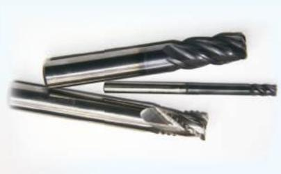
В процессе работы эти фрезы более эффективно сопротивляются возникновению резонансных автоколебаний, что положительно сказывается на стойкости инструмента и на качестве обработанной поверхности. Этот эффект достигается за счет смещения осевого расположения режущих кромок по длине режущей части.
