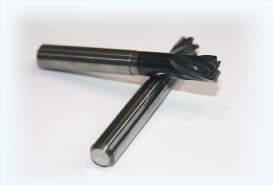
Основные преимущества фрез M146 заключаются в специальной конструкции торцевой части фрезы. За счет геометрии режущей кромки происходит перераспределение сил резания и значительное снижение толщины стружки, что позволяет увеличить значение подачи и получить шероховатость поверхности более высокого класса.
